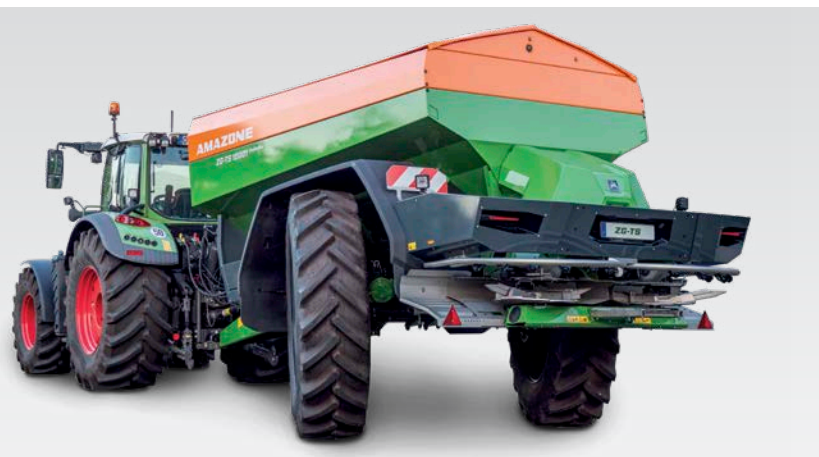
Essieu directeur avec un angle de braquage jusqu'à 28°
