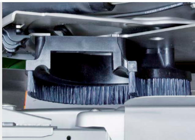
✔ Brosse pour une alimentation précise des aubes d'épandage
