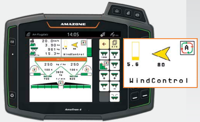
La vitesse et le sens du vent sont affichés sur le terminal
